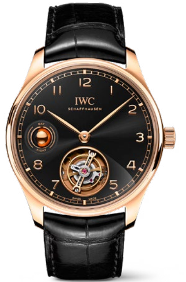
IWC PORTUGIESEER HAND-WOUND TOURBILLON DAY & NIGHT - IW545901 in 18 KT. Armor Gold®; Ø 42,4 mm; Zifferblattfarbe schwarz; schwarzes Alligatorlederband; beidseitig entspiegel- tes Saphirglas; IWC-Manufakturwerk mit Handaufzug Kaliber 81925, Fliegendes Minutentourbillon, Tag- und Nachtanzeige, Tourbillonmechanismus mit Stoppvorrich- tung; 84 Stunden Gangreserve; Wasser- dichtheit 6 bar.
